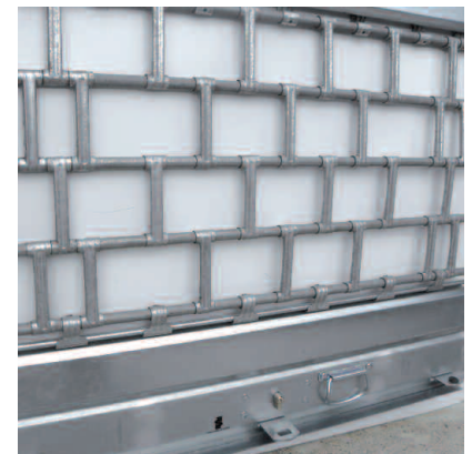
Modèle biellettes 9,5 kg/m 2 Tubes droits Ø 18 galvanisés Reliés par biellettes de 96 mm de hauteur
