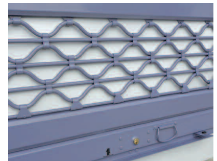
Modèle bijoutier 15 kg/m 2 , 2 tubes ondulés galvanisés Ø 14x1,1 renforcés par un tube droit intermédiaire
